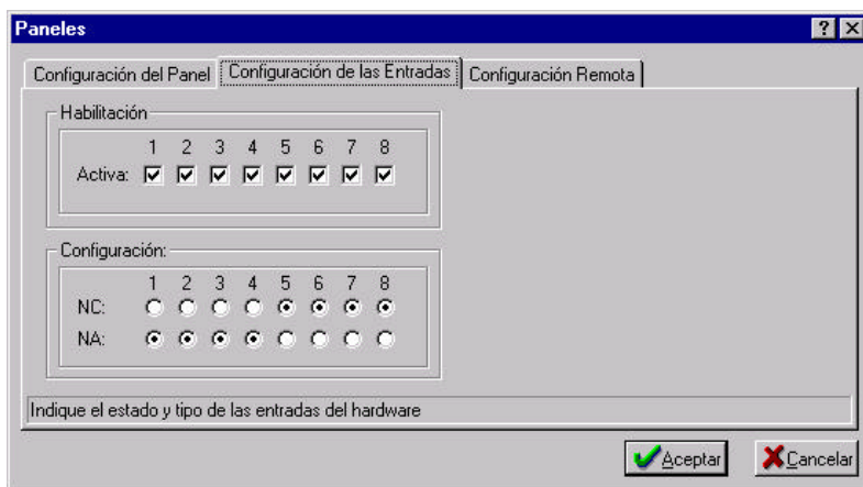
Figura 4.12.b. Ventana de edición de panel controlador (solapa “Configuración de las Entradas”).
