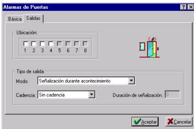
Figura 4.16.b. Ventana de edición de alarma de puerta (solapa “Salidas”).
